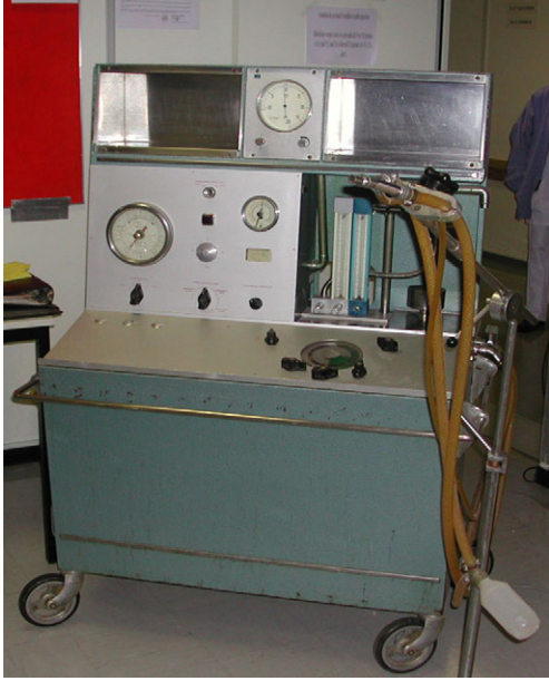
Figure 5 Le SF4™ était encore plus imposant que l'Engström. On note sur la partie horizontale du pupitre le chronotome avec ses boutons de découpage du cycle. Sur la partie verticale à gauche le volumineux cadran du spiromètre et plus à droite le manomètre de pression des voies aériennes avec une alarme. À l'étage supérieur, un autre manomètre disposait d'un amortissement mécanique de la variation de pression et indiquait une valeur approximative de la pression moyenne des voies aériennes. (Service d'URRM, hôpital Calmette, photographie C. Chopin).
