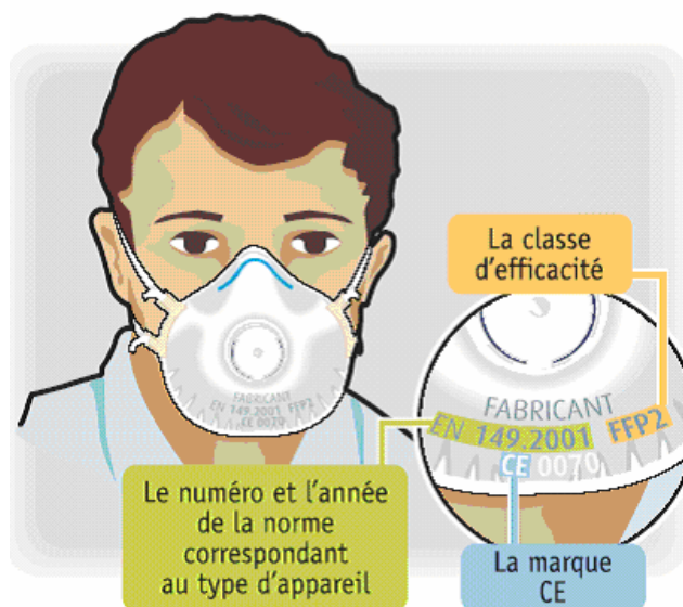
Figure 5 : Mentions obligatoires sur un appareil de protection respiratoire jetable contre les particules (document INRS)
