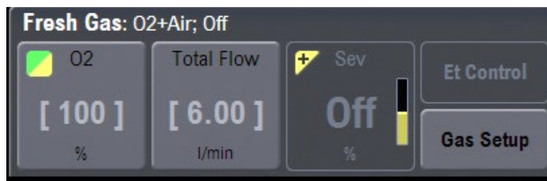
Illustration 4 : Spécification des paramètres de ventilation en bas débit
