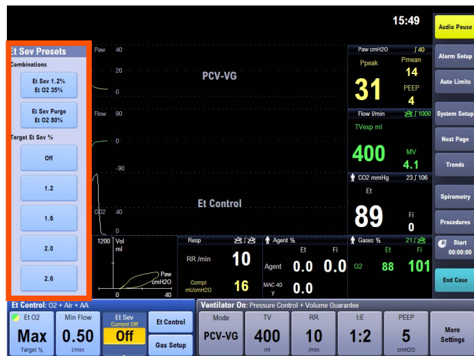
Illustration 8 : Pré-réglages de concentrations d'halogéné en fin d'expiration
