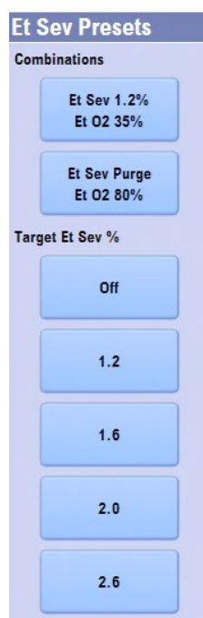
Illustration 10 : Choix des cibles préconfigurées des options de sélection rapide pour l'anesthésie à bas débit automatisée
