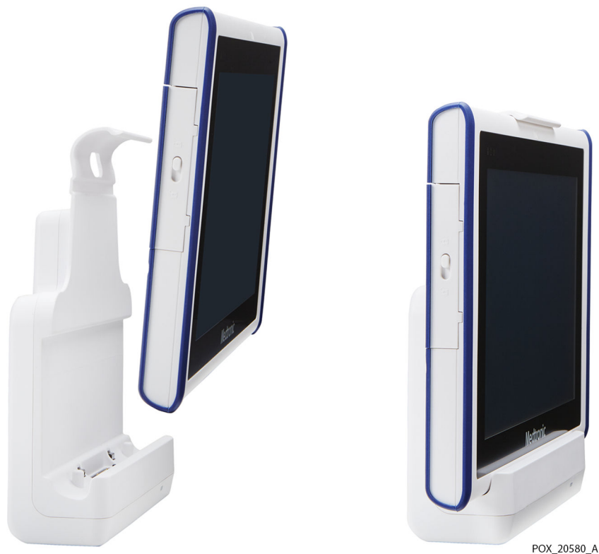
Figure 15. Moniteur monté dans la station d'accueil
